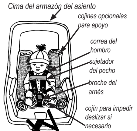
C. Partes de un asiento. Agrega cojines (en la figura) a los lados del bebé y detrás de la correa con hebilla solo cuando sea necesario.
